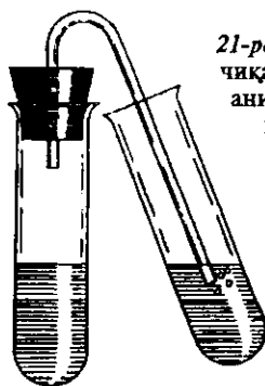
20-расм. Реакцияда ҳосил бўладиган газларни аниқлаш асбоби.
