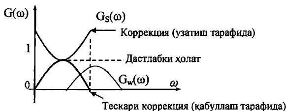
11.3-расм. Сигналга тўғри ва тескари коррекция киритиш.
