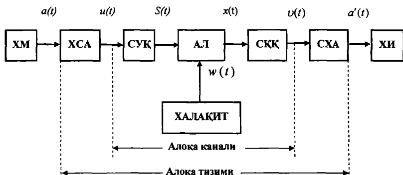
1.1-расм. Алоқа тизимининг структуравий схемаси.
