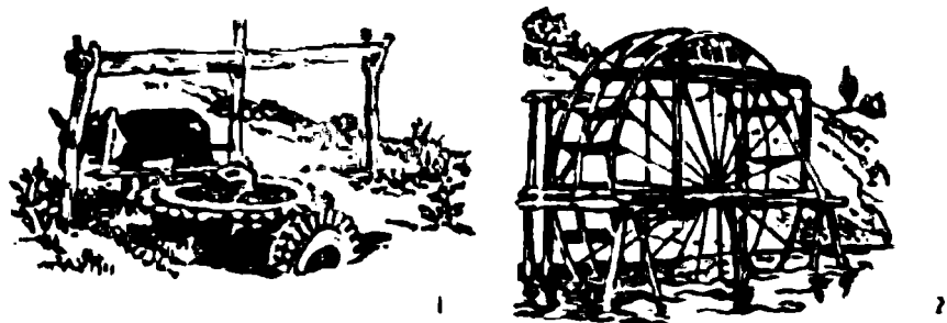
2-rasm. Chig'ir: 1 – sizot suvini ko'tarib beruvchi va 2 – daryodan suvni ko'tarib beruvchi charxpalak
