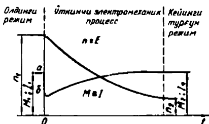
247- расм. Якорь занжирига қўшимча қаршилик киритиб двигателнинг айланиш частотасини ростлаш жараёни. Бунда: R_{н2} > R_{н1} ;
