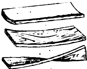
20-расм. Тоб ташлаш: а — кўндалангига; б — бўйига; в — винтсимон
