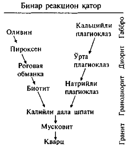
7.11-расм. Боуэн қатори. Кристалланиш натижасида минералларнинг кетма-кетлиги.
