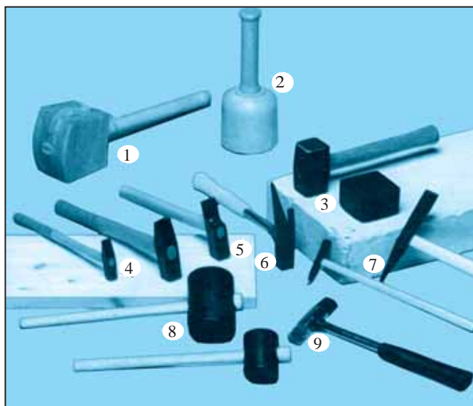
13-su'wret. Slesarli'q balg'alari' ha'm ag'ash toqpaq: 1,2 – ag'ash balg'alar; 3,4,5,6,7 – polat balg'alar;8,9 – plastik balg'alar.
