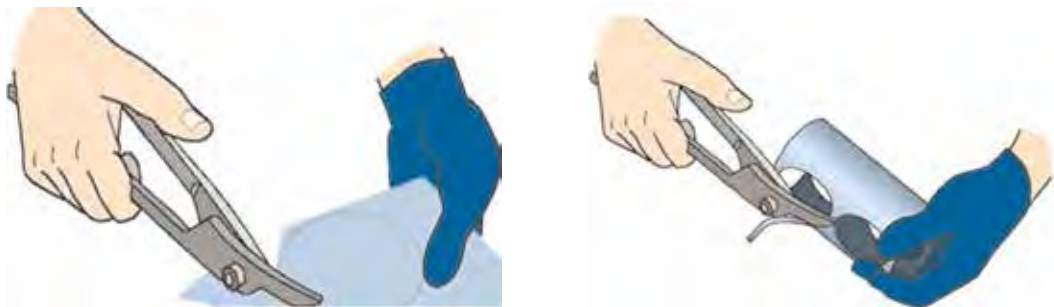
48-súwret. Qol qayshısı menen juqa list materialdı kesiw.
