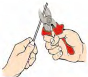
28-súwret. Simdı atawızda kesiw.
