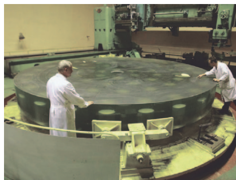
Расми 38. Ҷараёни сайқалдиҳӣ дар сеҳ ба оинаи телескопи диаметраш 8 метра.
