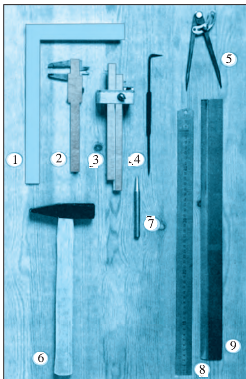
Расми 7. Анҷомҳои ченкунӣ ва банақшагири: 1. Кунҷаки 90°. 2. Паргори штапген. 3. Хаткашаки масштабнок. 4. Хаткашаки оҳанин. 5. Паргори нақшагири. 6. Болғаи челонгарӣ. 7. Фӯлодқалам. 8–9.Хаткашакҳо.
