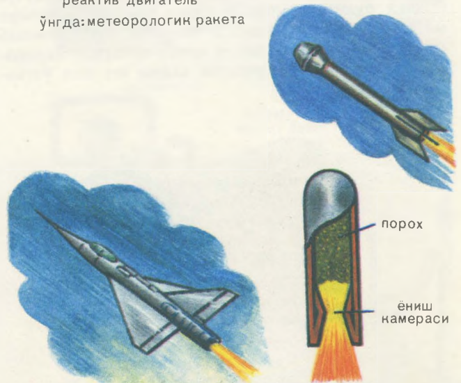
қаттиқ ёқилғида ишлайдиган ракета двигатели. юқорида: „Натюша“ минометнинг ракета снаряди
