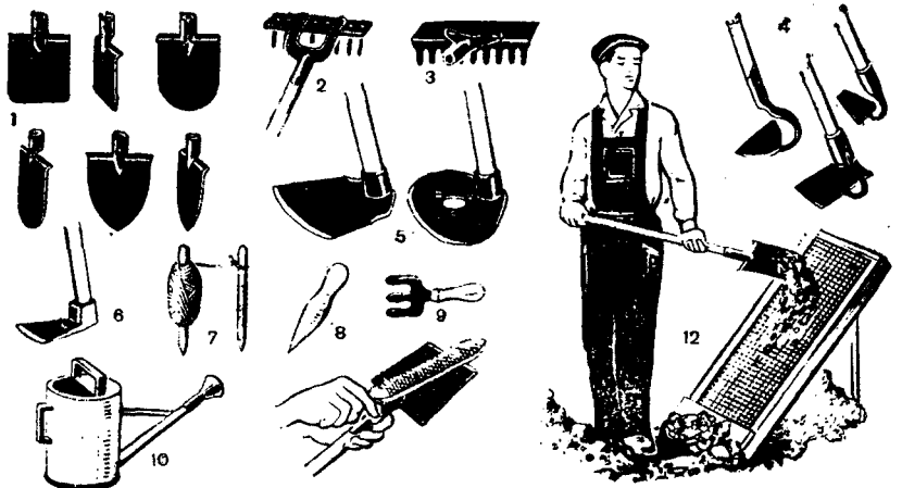
Томорқада ишлатиладиган асбоблар: 1—белк урак; 2—3 — темир хаскаш; 4—қўл мотигалари; 5 — кетмонлар; 6—теша; 7 — каноп; 8 — қозик; 9 — паншажа; 10 — гулчелак; 11 — эгос; 12 — галвир.
