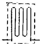
7-43- расм. Симли ўзгартиргичнинг схемаси.
