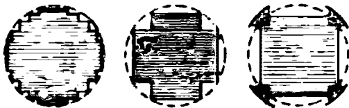
9-4- расм. Трансформаторлар ўзақларининг кесими.
