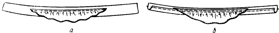
148-расм. Қирқимлари мағизланган икки томонлама қўйма бурма: а — қия бичилган газлама парчасини қирқимларни мағизлаш учун улаш; б — қия бичилган газлама парчасининг очиқ учларини бириктириб тикиш
